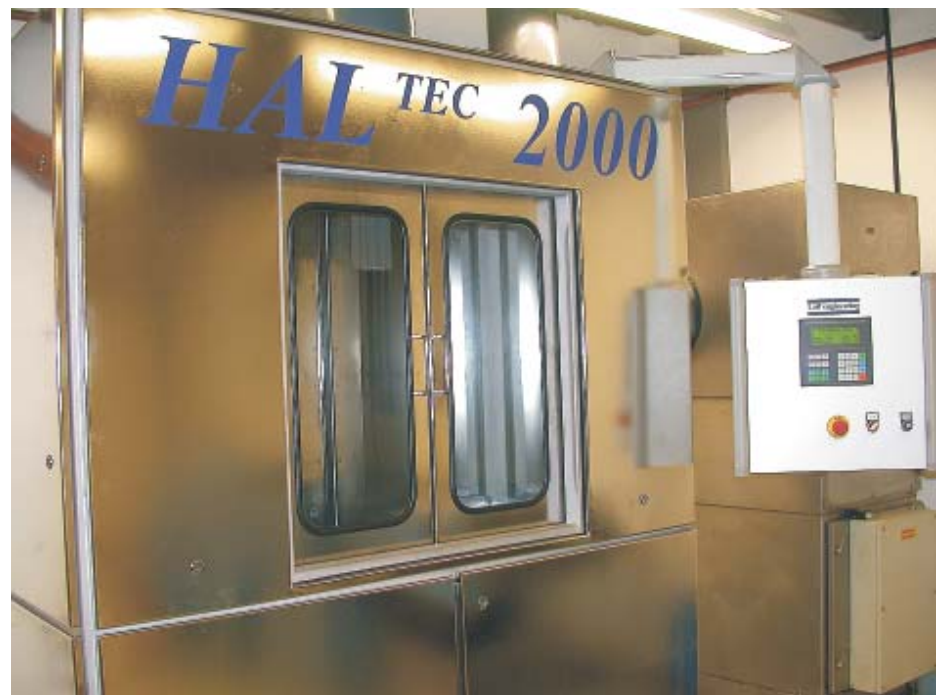
Hochmoderne, bei Dunkel + Schürholz installierte HAL-Anlage. Geschäftsführer Thomas Schürholz: „Die Heißluftverzinnung hat Zukunft - wenn man sich endlich auf eine einheitliche bleifreie Lotvariante einigt.“
