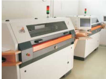
modernstes Fertigungsequipment bei Dunkel + Schürholz: Plasmareinigungsanlage (links) und Fingertestsysteme
